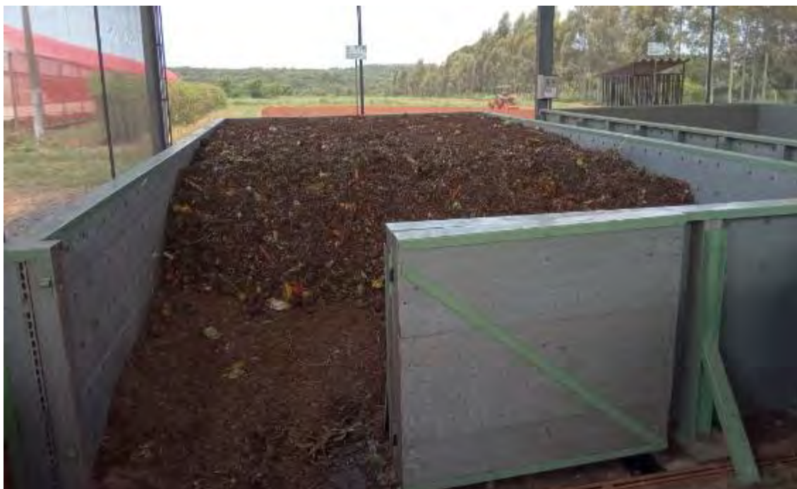
Foto 17 - Pilha Estática de compostagem com aeração forçada.
