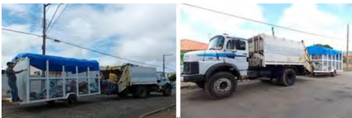
Foto 20 - Carreta simples para o transporte de resíduos orgânicos segregados, acoplada a veículo de coleta.
