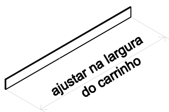
PEÇA "C" (2 unid) Travas em barra de ferro chato 20 mm - e= 0,5mm
