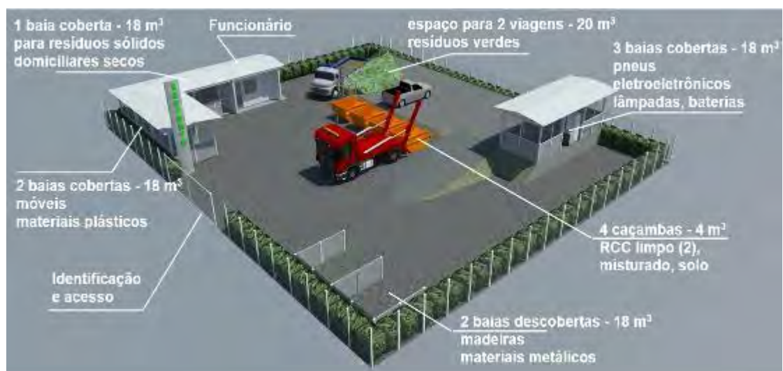
Figura 9 - Dimensionamento do Ecoponto Padrão.
