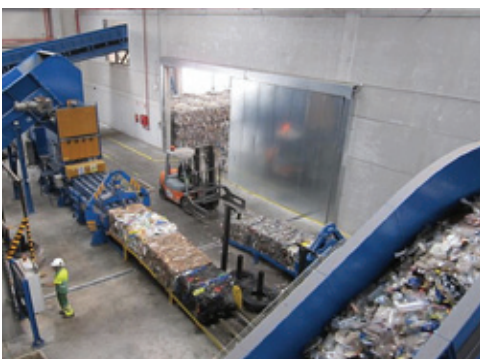
Figura 20 TMB – segregação das embalagens e biodigestão seca dos orgânicos
